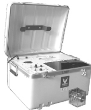
Gambar-2 Perangkat pengukuran tegangan tembus Liquid Dielectric Test Set, Model LD60
