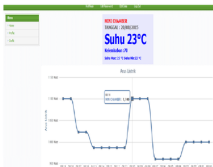
Gambar 5. Tampilan GUI web browser akuisisi data daya dan suhu kelembaban Anechoic Chamber
