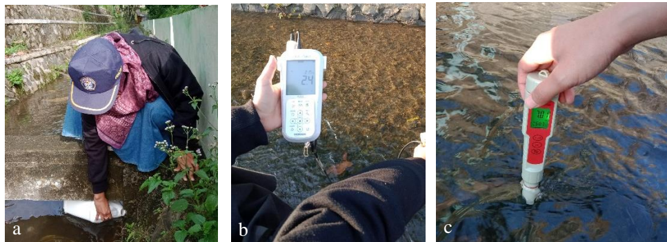
Gambar 2. (a) Proses Pengambilan Sampel Effluent IPAL Komunal; (b) Pengukuran Parameter Fisika Menggunakan Horiba Water Checker ; (c) Pengukuran Parameter Fisika Menggunakan pH Meter
