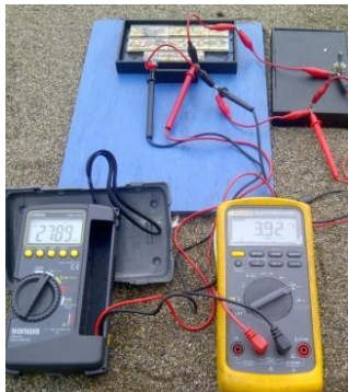
Gambar 7. Pengujian charger sel surya dengan media cahaya matahari
