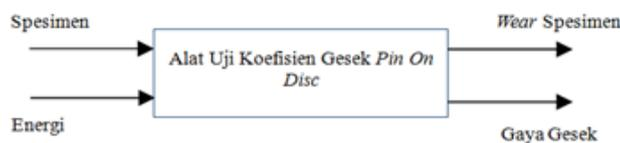
Gambar 3 Blok fungsi alat uji *pin on disc*.
