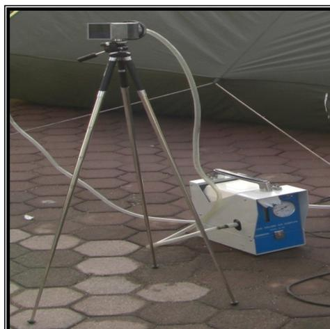
Gambar 1. Alat LVS untuk Sampling PM<sub>10</sub>
