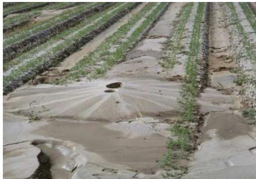
**Gambar 3. Semburan pasir ke atas permukaan tanah karena *sand boiling* (Brennan, 2008)**
