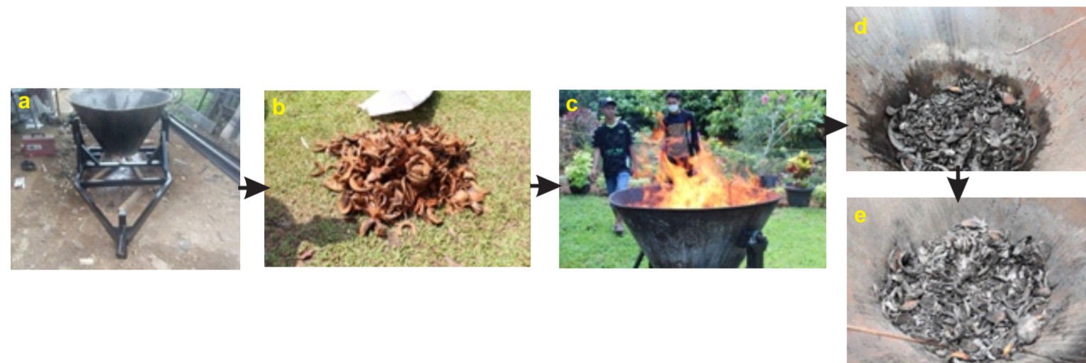
Gambar 1. a. Tungku pirolisis Kon-Tiki. Proses Pembuatan Biocar: b) Bahan baku sabut kelapa setelah dikeringkan, c) Proses pirolisis, d) Penyiraman dengan air, e) Bahan jadi Biochar untuk selanjutnya dihaluskan
