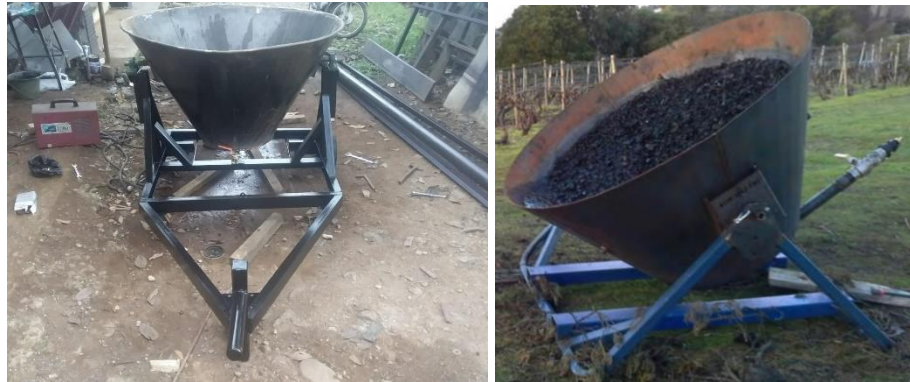
Gambar 2. Reaktor pirolisis model Kon-Tiki a) Reaktor pirolisis tampak dari depan, b) Model lingkaran reaktor pirolisis tampak dari samping atas.
