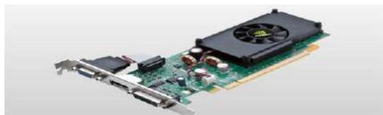
VGA Card (*Virtual Graphic Array*) merupakan suatu perangkat keras komputer yang digunakan untuk mengolah dan menerjemah output ke dalam monitor. **VGA Card** sering juga dikatakan sebagai Video Graphic Adapter. Kehadiran VGA Card dalam sebuah komputer tidaklah memberikan pengaruh yang besar seperti komponen vital komputer lainnya. Penggunaan VGA lebih mengarah kepada hal yang berhubungan dengan grafis, seperti desain 3D ataupun gaming.
