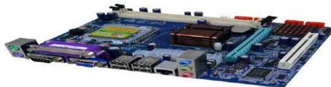
Secara sederhana, [motherboard](#) atau biasa disebut dengan Mainboard, Baseboard adalah Papan Sirkuit Cetak (*Printed Circuit Board – PCB*). Papan ini menjadi salah satu komponen terpenting dalam sebuah komputer. Sebab, dengan adanya motherboard setiap komponen utama dalam komputer dapat berhubungan dengan komponen lainnya. Motherboard inilah yang menampung seluruh komponen yang memiliki peran penting dalam sistem, seperti CPU, slot RAM, VGA Port, USB Port dan lainnya.
