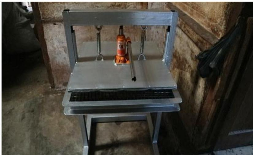
Gambar 7.8. Alat Pemotong Kulit.
