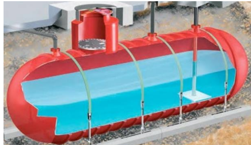
PENYEDIAAN GROUND TANK
