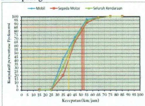
Gambar 15. Persentil 85<sup>th</sup> dari kecepatan kendaraan di lokasi pekerjaan marka
