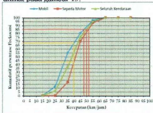
Gambar 13. Persentil 85<sup>th</sup> dari kecepatan kendaraan di lokasi pekerjaan patching
