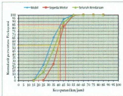
Gambar 7. Persentil 85<sup>th</sup> dari kecepatan kendaraan di lokasi pekerjaan perkerasan aspal
