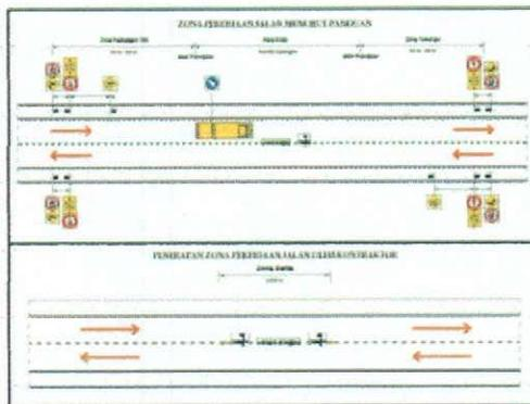
Gambar 14. Penerapan zona pekerjaan jalan pada pekerjaan marka
