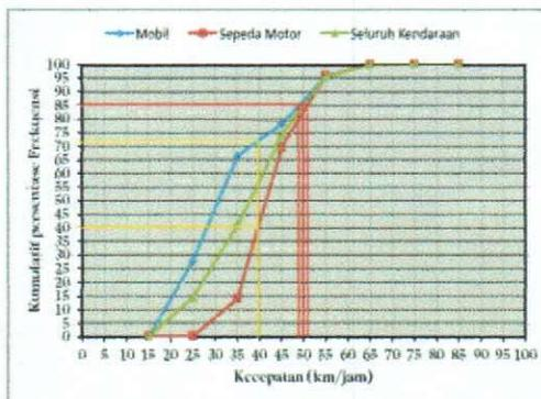
Gambar 9. Persentil 85<sup>th</sup> dari kecepatan kendaraan di lokasi pekerjaan bahu jalan
