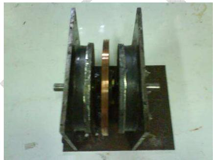
Foto 2. Generator homopolar magnet permanen kutub ferro pada kondisi plat ferro dipasang
