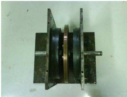
Foto 1. Generator homopolar magnet permanen kutub ferro pada kondisi plat ferro dibuka
