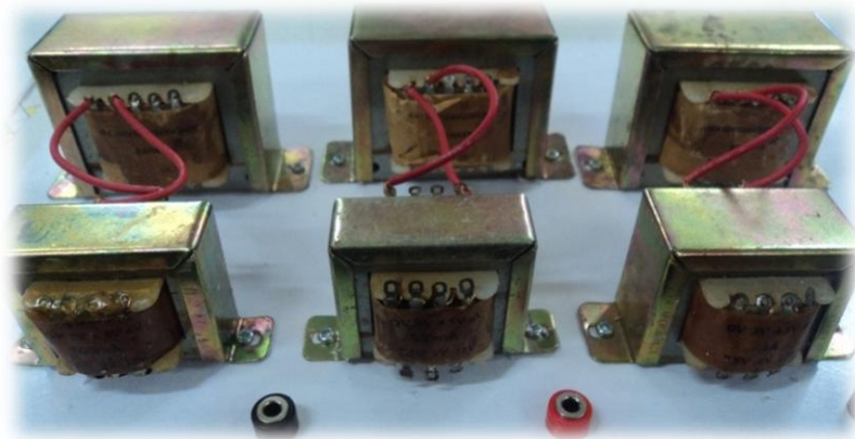
Gambar 3.4. Transformator yang digunakan untuk menaikkan tegangan dari generator.
