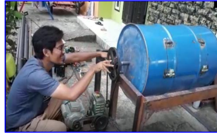
Pemasangan Pully 20 inci pada AS
