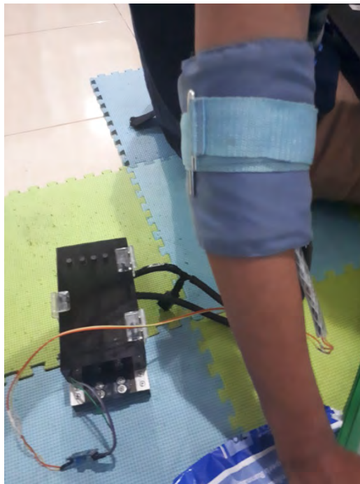
Gambar 4.14 Pemasangan sistem pada sendi anggota gerak user .
