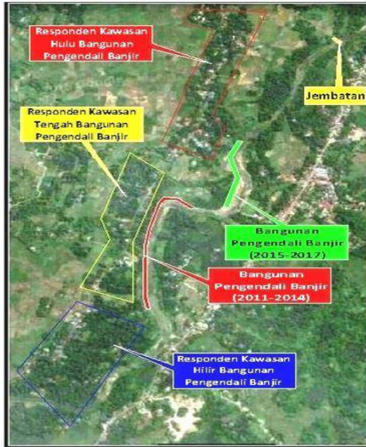
Gambar 1 Denah Bangunan Pengendali Banjir dan Pembagian Responden
