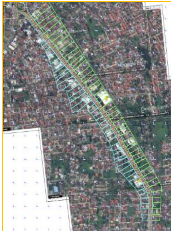
Gambar 6. Pembagian daerah tangkapan air pada setiap ruas saluran (Pengolahan data, 2017)
