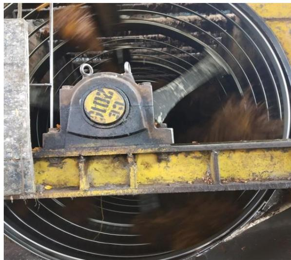
Gambar 17. Proses pemisahan brondol dengan janjangnya menggunakan *stripper*.
