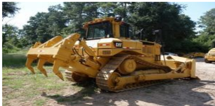
Gambar 1. Dozer Ripping yang digunakan
