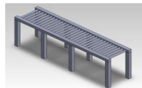
Gambar 6. Alternatif 2 Alat Bantu Konveyor dengan Kaki 8
