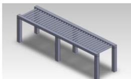
Gambar 5. Alternatif 1 Alat Bantu Konveyor dengan Kaki 6
