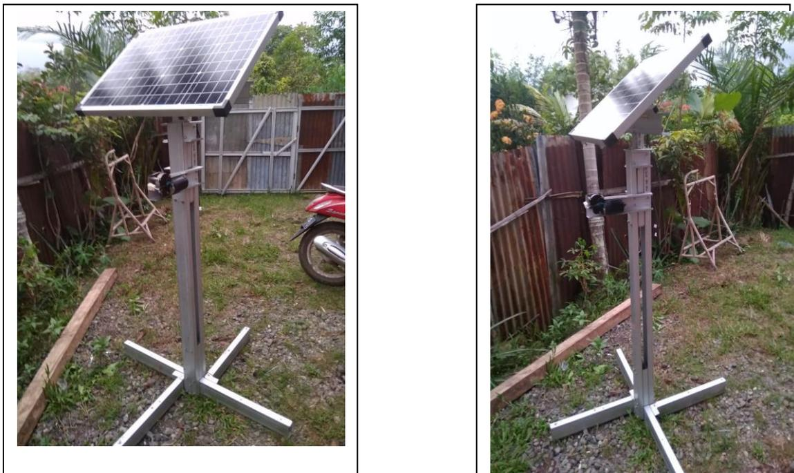
**Gambar 6.** Bentuk Alat Penghalau Burung Otomatis
