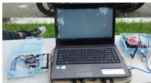
Gambar 4.3 Pengambilan data transceiver dengan penghalang
