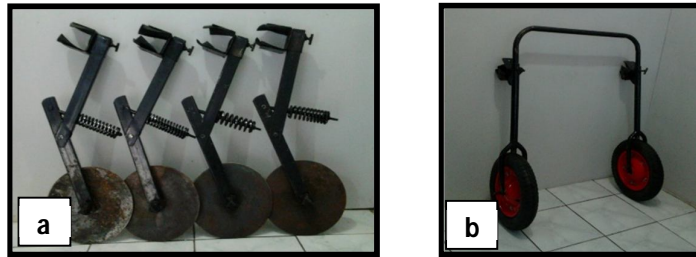
Gambar 6. (a) Disain elektroda electrical resistivity berupa disk yang akan diimplementasikan pada lahan gambut (tampak dari samping). (b) Disain perangkat roda yang akan dipergunakan.
