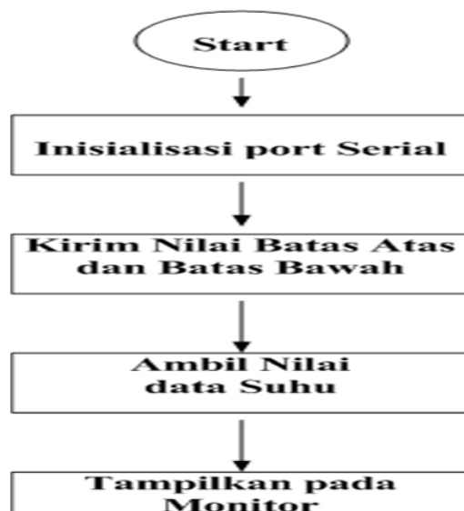
Gambar 4. Diagram alir VB 6.0 pada PC
