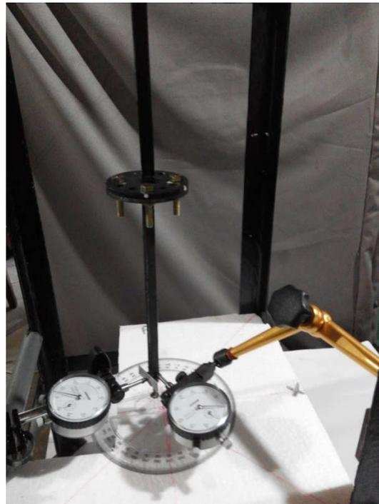
Gambar 4. Alat uji balok jepit dengan orientasi penampang berbeda
