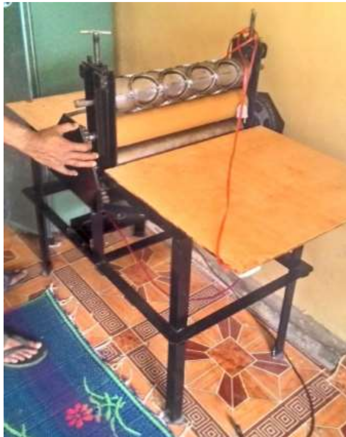
Gambar 4.8. Produksi Mesin Roll Press dan Cetakan Mekanis Kerupuk Ubi
