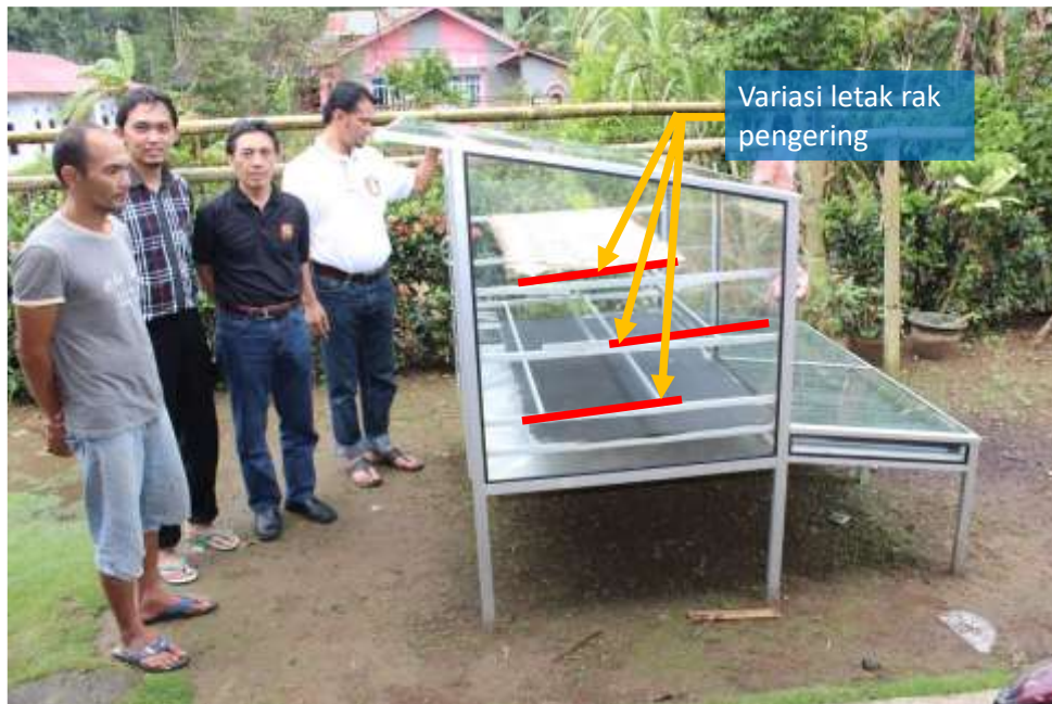
Gambar 2.1. Greenhouse dryer dan variasi letak rak pengering (Dendi, dkk, 2015)
