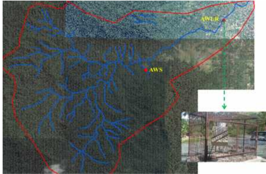
Gambar 5. Lokasi pos cuaca otomatis ( automatic weather station/AWS ) dan pos pencatat tinggi muka air otomatis ( automatic water level recorder/AWLR ) di DAS Paninggahan. AWS berlokasi di Kampung Aro dan AWLR berada dibendungan Batang Sabarang. Inset foto merupakan kondisi logger AWLR yang telah rusak (hasil survei, 19-April-2017)
