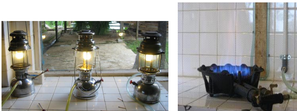
Gambar 6. Penggunaan biogas untuk penerangan dan kompor gas
