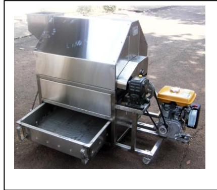
Gambar 1. Mesin sangrai kopi bahan baku arangkayu
