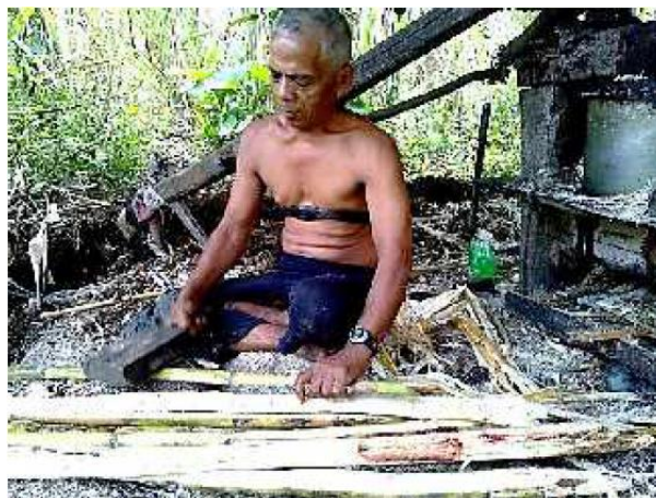
Gambar 3.2 Posisi Duduk dan Tangan Operator Ketika Memukul Tebu
